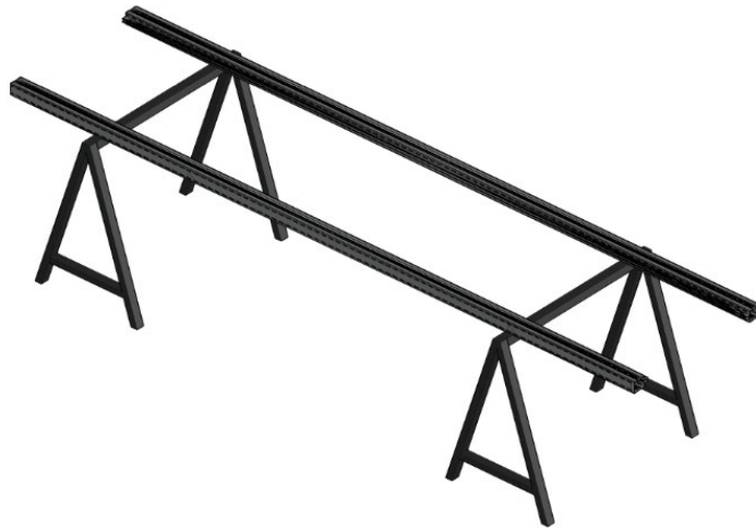
Abb. 44 Ständerprofile zur Ausrichtung der Ständertiefe auf Unterstellböcken aufgelegt
