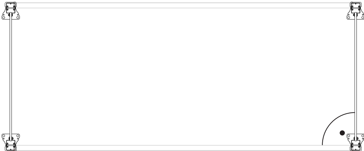
Abb. 76 Rechtwinkligkeit des Regalfeldes
